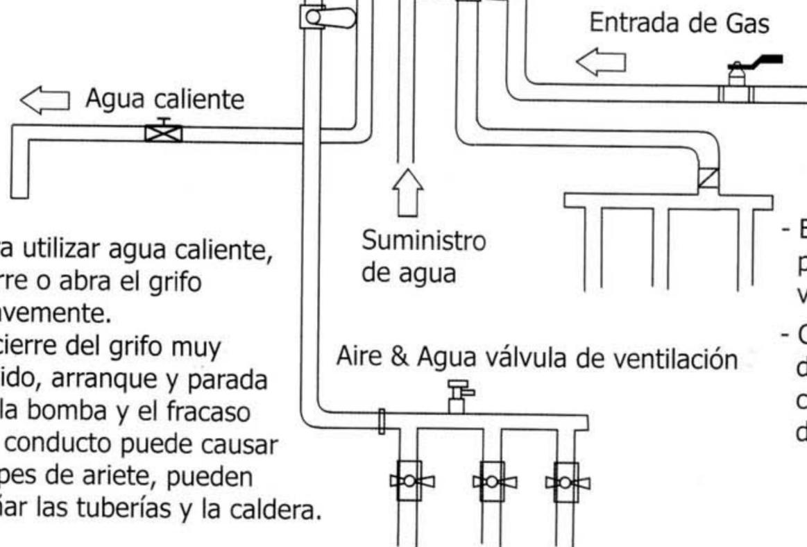
Para utilizar agua caliente, cierre o abra el grifo suavemente. El cierre del grifo muy rápido, arranque y parada de la bomba y el fracaso del conducto puede causar golpes de ariete, pueden dañar las tuberías y la caldera.
