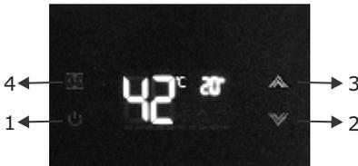
1. Botón de encendido y apagado. Usar como tecla de confirmación cuando se configuran parámetros del menú interno.
